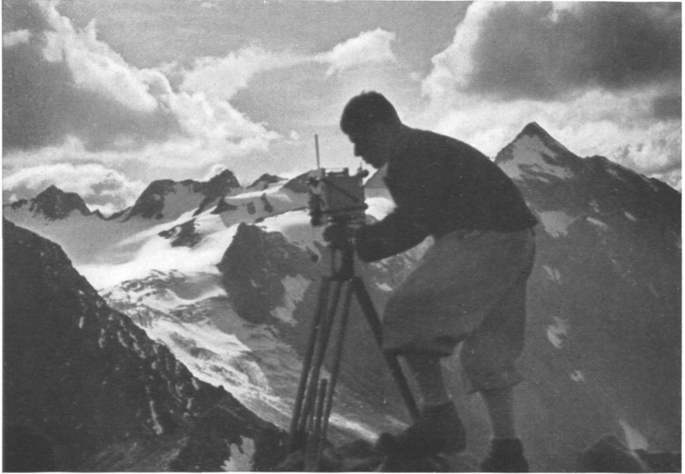
Bild 5. Der leichte Feldphototheodolit im Gebrauch
