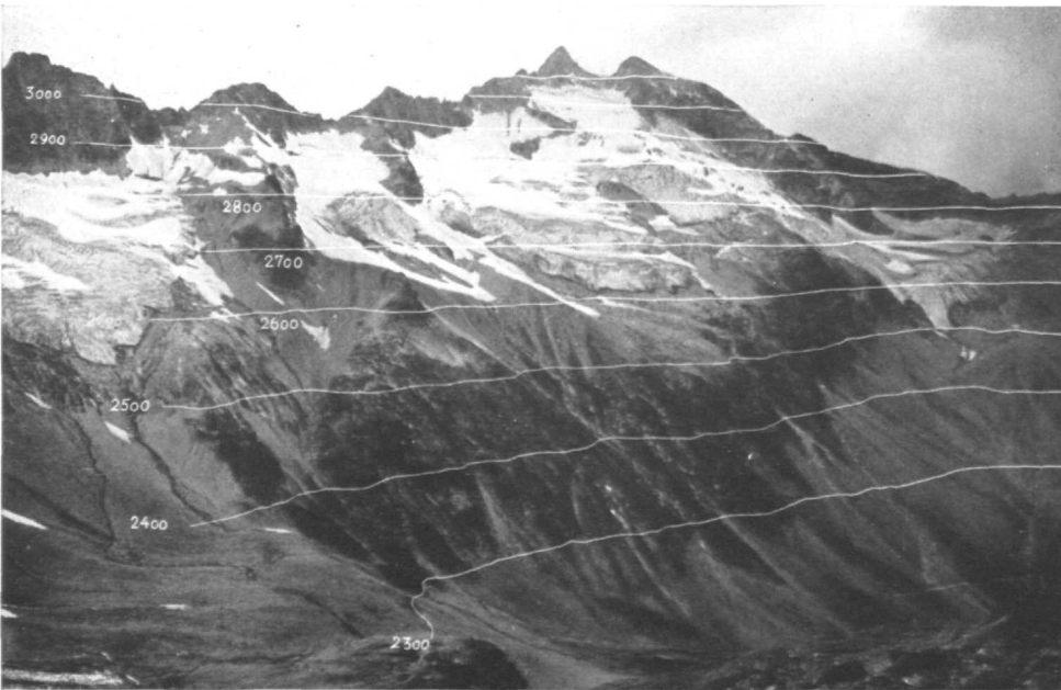
Bild 8. Linke Aufnahme (A) der Standlinie Windbadhtalkopf gegen Reichen Spitze normal Mit eingetragenen perspektivischen Höhengsichten, die mit dem Stereautographen während der Ausarbeitung gezogen werden
