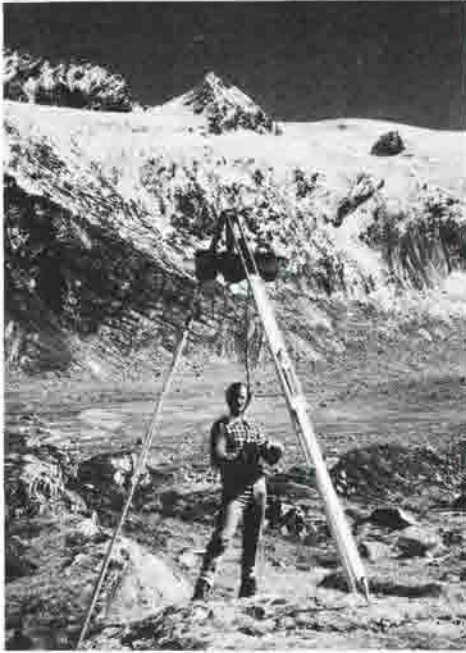
Abb. 7: Fototheodolit Wild C 40 mit Spezialstativ im Vorfeld des Schwarzensteinkeeses gegen Gr. Mörchner und Schwarzensteinsattel. Am Instrument Th. Wintges. Aufn. M. Fink, 29. 8. 1976.
