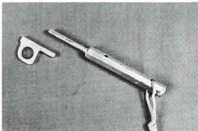
*Bild 1: Konventioneller Bohrhaken mit Stiftbohrer (heute kaum mehr verwendet).*
