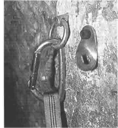
Ein Bohrhaken mit angerosteter Schraube M8 (schon im Neuzustand festigkeitsmäßig unzureichend). Daneben die zweite Bohrhakengeneration (Mammuthaken, schlecht gesetzt).
