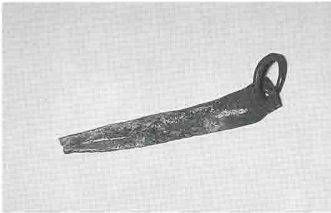
Ein aus einem Stück Wasserrohr selbstgebastelter Ringhaken, dessen unteres Schaftende einen Längsriß aufwies. Dieser Längsriß reduziert die Klemmwirkung, da der Haken im Rißbereich keine Radialkraft mehr aufnehmen kann.
