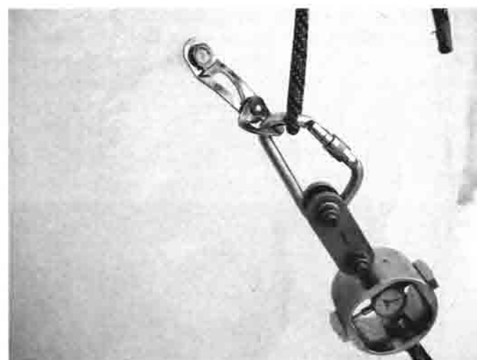
EISSCHRAUBEN WERDEN AUF IHRE VERSAGENSFESTIGKEIT GESTESTET.
