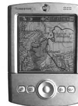
MIT DEN „ALPENVEREINSKARTEN DIGITAL“ UND ZUSATZSOFTWARE IST ES MÖGLICH, DIE KARTEN AUF EINEM PALM ZU BETRACHTEN UND MIT EINEM ANGESCHLOSSENEN GPS-EMPFÄNGER SEINEN EIGENEN STANDORT FESTZUSTELLEN.
