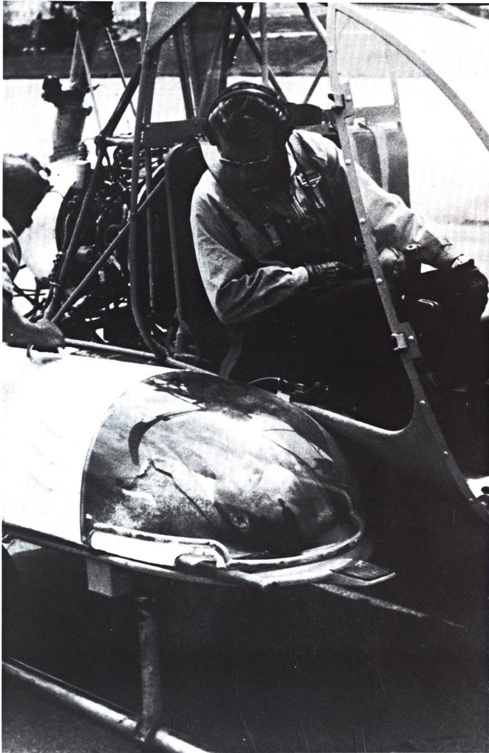
Abb. 2: Notfallpatient auf einer mit Plexiglaskuppel verkleideten Außentragbühne des Hubschraubers der Type „Djinn“ (1956). Eine Betreuung während des Fluges war nicht möglich.
