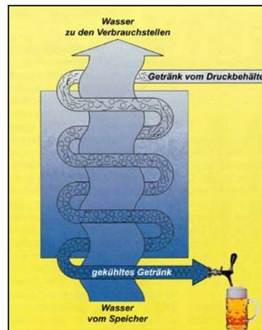
Abb. 13: Funktionsschema des Getränke Kühlers
