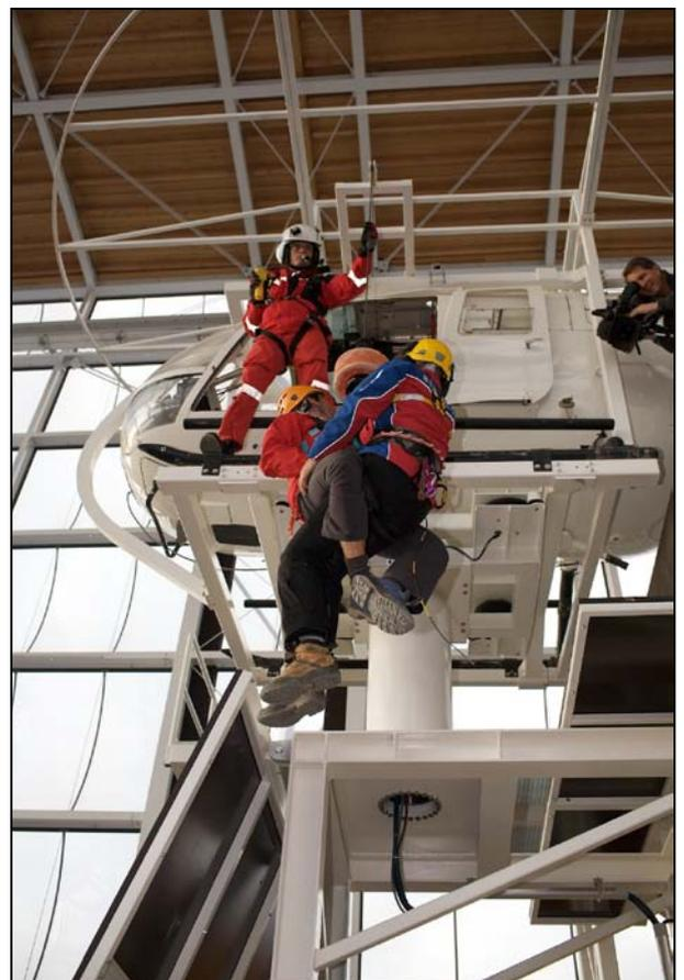
In dem 20 Meter hohen Gebäude wird durch die einzigartige Kombination der transparenten Architektur, durch die Kran- und Steuertechnik und durch die originalgetreue Hubschrauberzelle das Gefühl eines echten Einsatzes vermittelt. Authentisches Freiraum-Gefühl und die Beweglichkeit der Zelle lösen die Grenzen zur Wirklichkeit auf. Der echte Hubschrauber, die echte Bewegung, der echte Wind, Lärm und die echte Höhe mit echten Einsatzszenarien erzeugen darüber hinaus das notwendige Risikobewusstsein.
