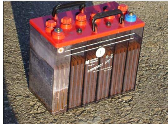
Abb. 7: Defekte Batteriezelle
