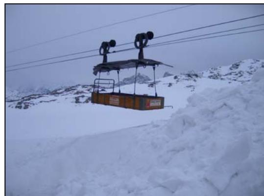
Abb. 9: Transportkiste der Materialseilbahn
