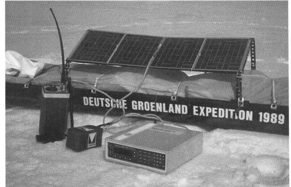
Die mobile Satellitennavigationsstation
