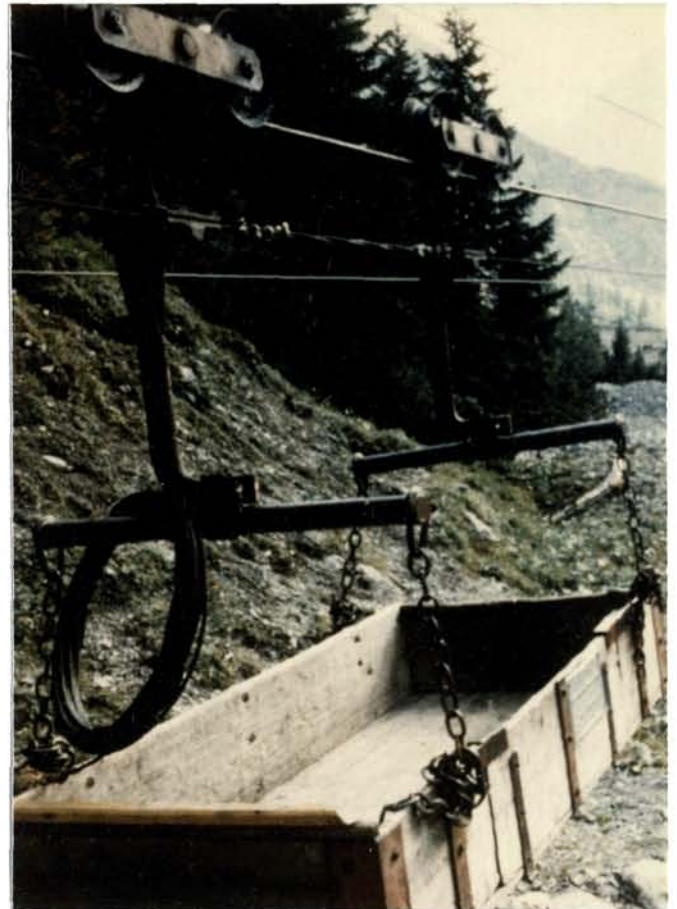
Förderkiste der Materialseilbahn
