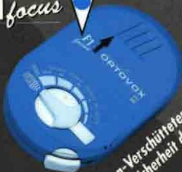
Lawinen-Verschüttelensuchgerät mit „Ampelschaltung“
