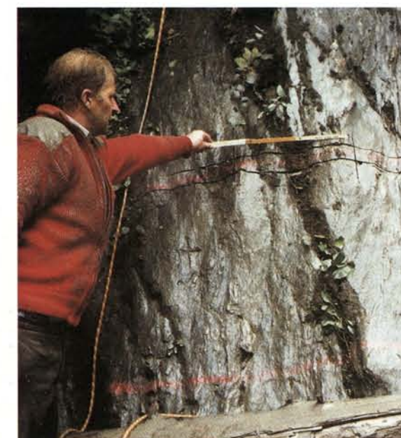
Oben: Der Bergmann Günther Schaffarczyk bei der Schlitzprobennahme von 1989. Fotos Johannes K. Bauer.
