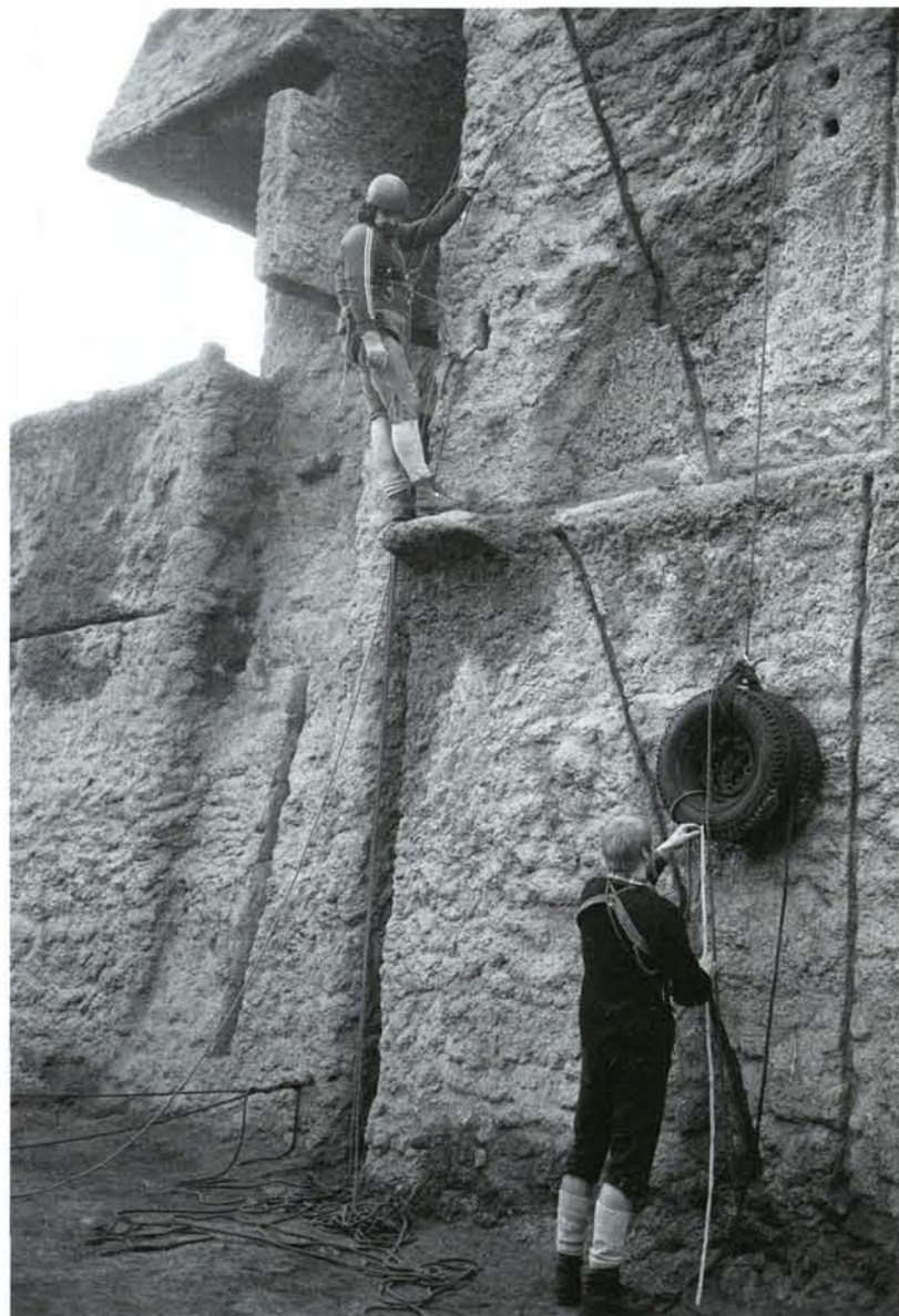
Sturzttest am Kletterturm. Reaktionsschnelligkeit und Bremskraft des Sichernden können anschließend zentimetergenau mit dem Zollstock gemessen werden. Foto: Udo Preugschat
