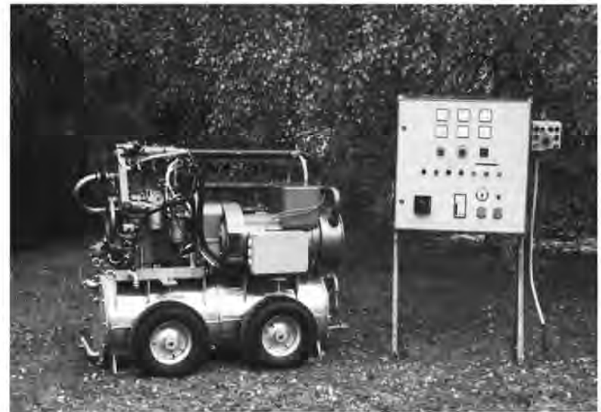
Blockheizkraftwerk vor der Installation
