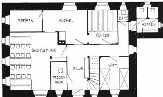
Das Haus bietet eine großartige Rundschau und ist von Mallnitz und Böckstein aus sichtbar; es ist ganz aus Trockenmauerwerk erbaut, innen und außen verputzt, ferner innen mit Asbestplatten und darüber mit Holztäfelung bekleidet und mit Eternitplatten gedeckt; die Blitzschutzanlage ist die gleiche wie beim Elisabethhaus.
