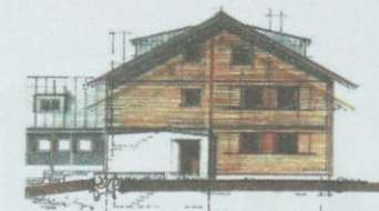
LINDAUER HÜTTE 2008 - ANBAU EINES TREPPENHUPFANGS - UMBAU VON EG/1.OG + DG.
