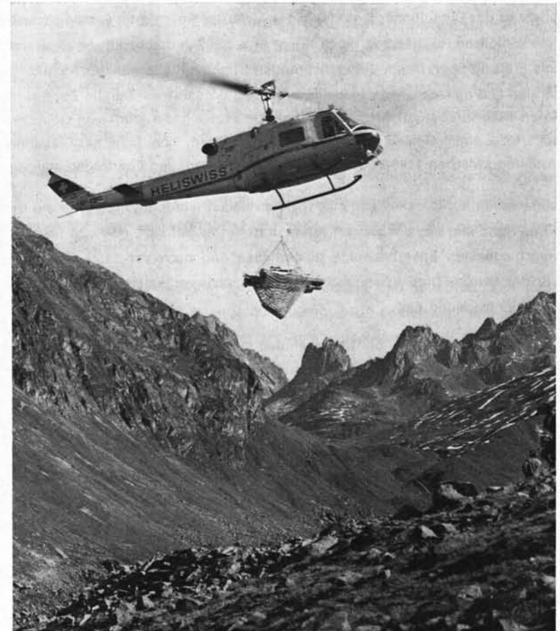
Hubschrauber-Transport von DRIESCHER-Schaltgeräten zur Hochgebirgs-Trafostation der Heilbronner Hütte, 2320 m, Verwall/Osterreich
