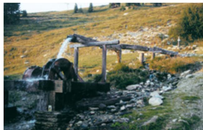
Ein Butterfass wird durch Wasser gedreht
