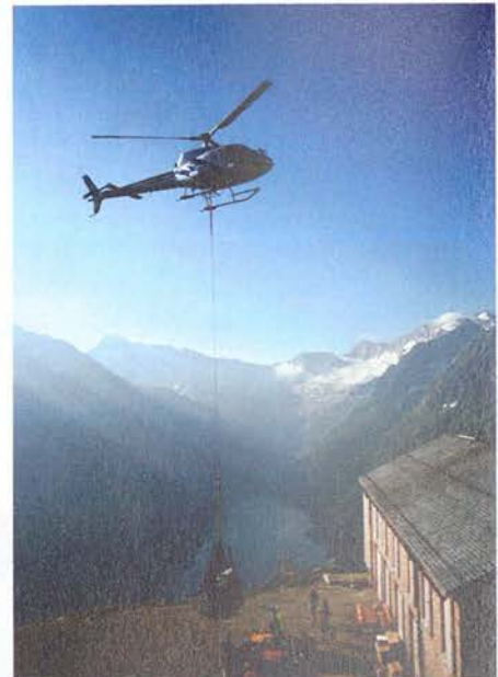
Helikoptertransport Zeitaufwand: alle 3 bis 4 Wochen ca. 16 Stunden Ladefähigkeit pro Flug: ca. 700 kg Beteiligte Personen: mindestens fünf Kosten: 1 Flugstunde kostet netto 20 bis 30 Euro (abhängig von der Hüttenlage) An- und Abflugsgebühren: Durchschnitt 150 Euro Zusätzliche Kosten: Transport bis zum Helikopterlandeplatz (Zulieferant bzw. zusätzliches Personal im Tal) und Entsorgungstransport Bildrechte: © Katharina Deum, Ölperer Hütte
