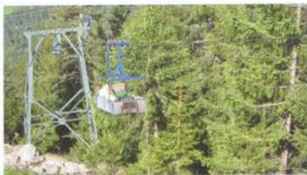
Seilbahn Zeitaufwand: ca. 2 bis 10 Stunden pro Woche Ladefähigkeit pro Seilbahnfuhr: ca. 250 kg Beteiligte Personen: mindestens zwei Kosten: Seilbahnpacht, Treibstoffkosten bzw. Stromaufwand, Wartungskosten Zusätzliche Kosten: Transport bis zur Seilbahnstation Zulieferant bzw. zusätzliches Personal im Tal und Entsorgungstransport, jährliche Revisionsprüfung der Seilbahn ca. 3 000 bis 5 000 Euro © Hans-Peter Gollberger, Brunnenhütte
