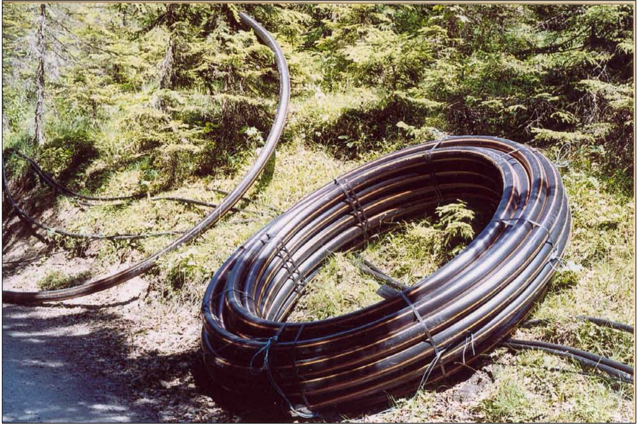
Das Abwasserrohr PE 100 90 x 8,2 mm
