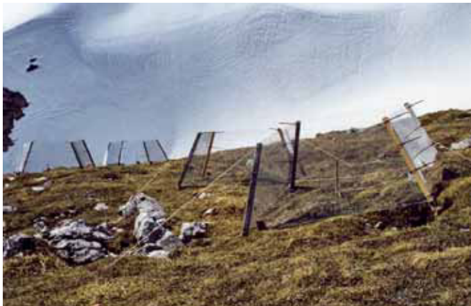
Abb. 5: Oben offene Mini-Gewächshäuser (OTCs) zur experimentellen Temperaturerhöhung im Gipfelbereich des Hohen Bretts (2.331 m ü. NN; Nationalpark Berchtesgaden). Durch einen Vergleich von derart erwärmten Flächen mit nicht erwärmten Kontrollflächen können die Auswirkungen einer Temperaturerhöhung auf die Vegetation untersucht werden.
