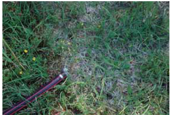
Abb. 4: Hauptschlauch (grün) mit abzweigenden Schläuchen (schwarz-rot) für die Karstwassereinspeisung in der Altfläche. Der Karstwasserzustrom ist öfters, wie gerade hier sichtbar, unterbrochen.
