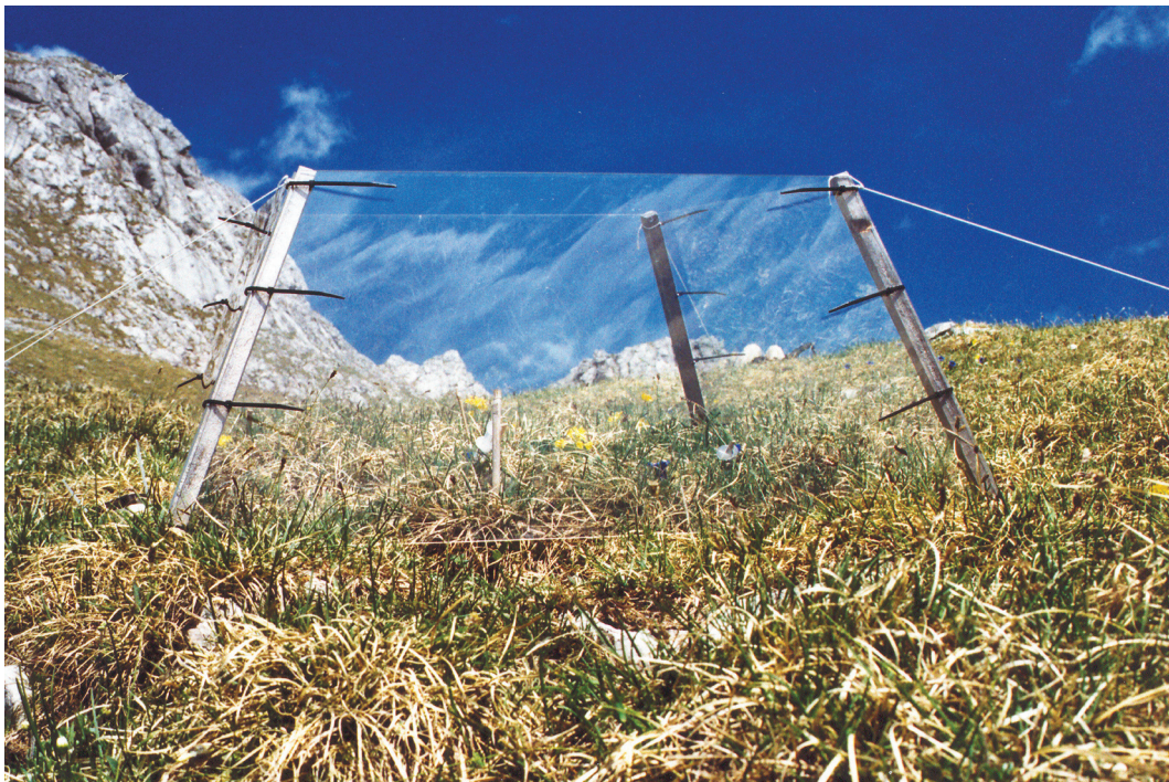
Abb. 1: Oben-offenes Mini-Gewächshaus (Open Top Chamber ; OTC) zur Erhöhung der Umgebungstemperatur der Pflanzen sowie der Oberbodentemperatur im Bereich des Blaugras-Horstseggenrasens.
