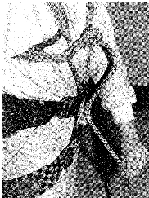
Abb. 43: Im Seillifter fixiertes Seil.
