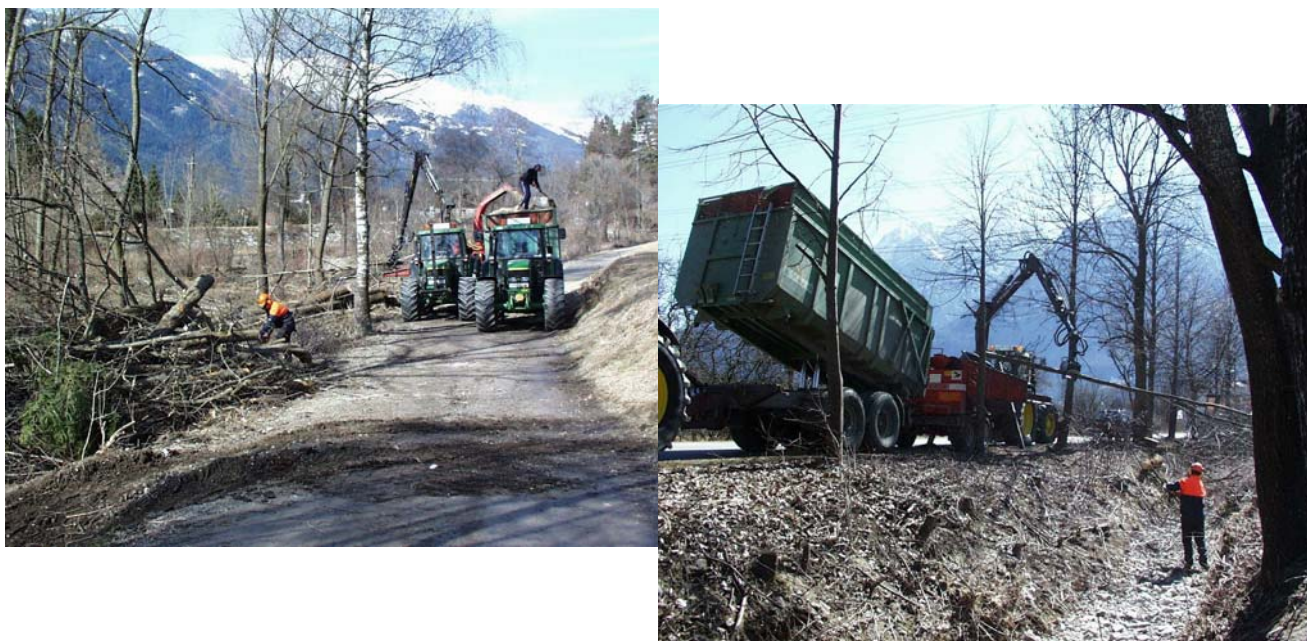
Abb. 5 und 6: Einsatz eines Großhackers bei der Waldbewirtschaftung in Ablagerungsplätzen, Bachläufen und Uferbereichen mit Verwertung als Energieholz für Biomasseheizwerke
