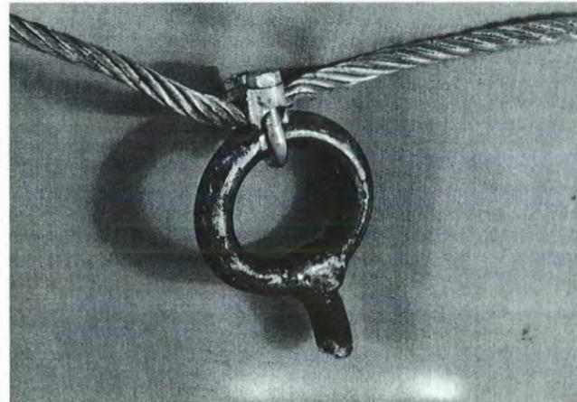
Eine beim Fallversuch abgerissene Stahlseilverankerung.
