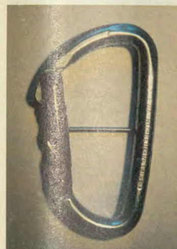
Karabinerprüfung in Querrichtung
