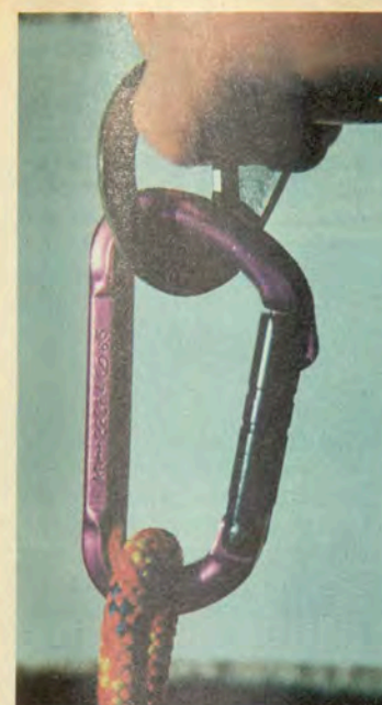
Karabiner-Normalbeanspruchung bei Zug in Längsrichtung. Der Karabiner sollte in solcher Position normalerweise um 180° nach unten gedreht sein
