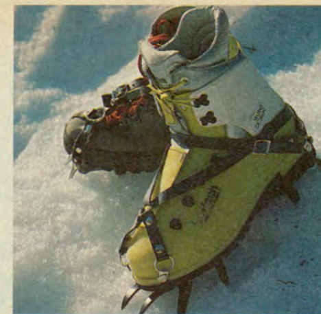
Steigeisenbindungen (s. Text und Zeichnungen S. 392/393) müssen den Schuh absolut sicher halten
