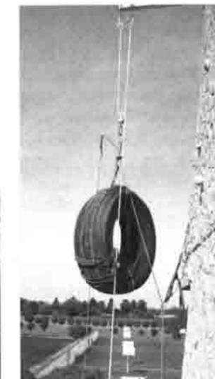
Lange Jahre war die Ausgleichsverankerung das Maß aller Dinge. Durch die Sturzversuche der Sicherheitsforschung wurden jedoch Probleme für den Sichernden bei der Bedienung des Sicherungsgerätes an der Ausgleichsverankerung deutlich. Ein vergleichender Test zeigte, dass bei soliden Fixpunkten die Reihenschaltung vollkommen ausreicht. Die Lehrmeinung wurde in Absprache mit den DAV-Lehrteams umformuliert. Ein Bericht im Panorama ist in Vorbereitung.
