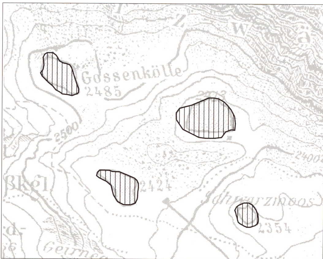
Abb. 9: Maschenweise Transformation im Bereich Gössenkölle: Hintergrund (grau): Transformierte Alpenvereinskarte. Vordergrund (schwarz): Auf der ÖK 50 digitalisierte Seen.
