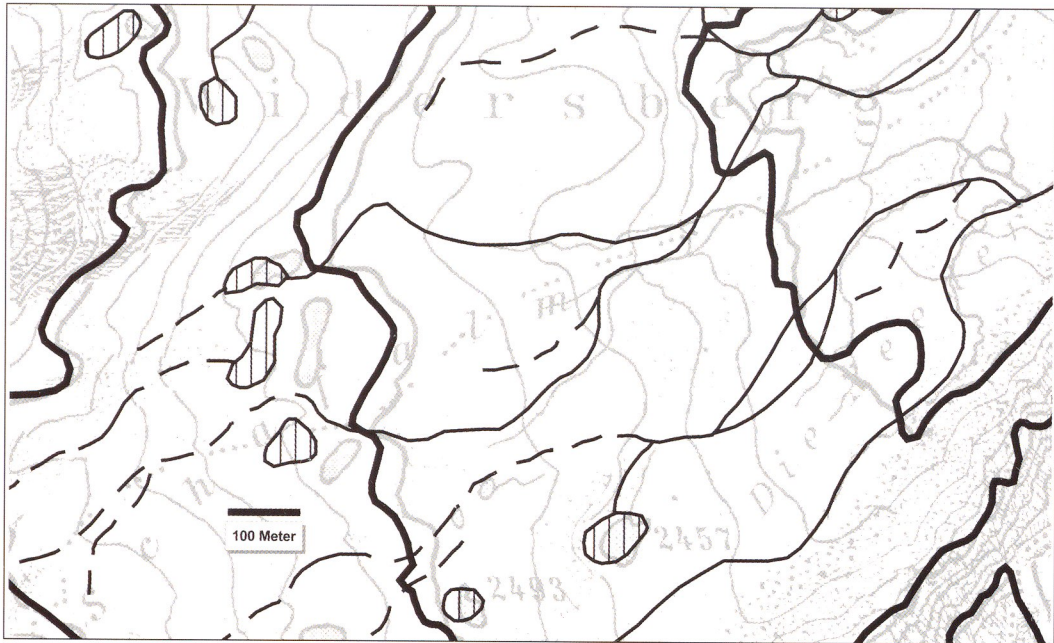
Abb. 10: Transformation 4. Ordnung im Bereich Widersberg: Hintergrund (grau): Transformierte Alpenvereinskarte. Vordergrund (schwarz): Auf der ÖK 50 digitalisierte Seen, Bäche und 100 m–Schichtlinien.
