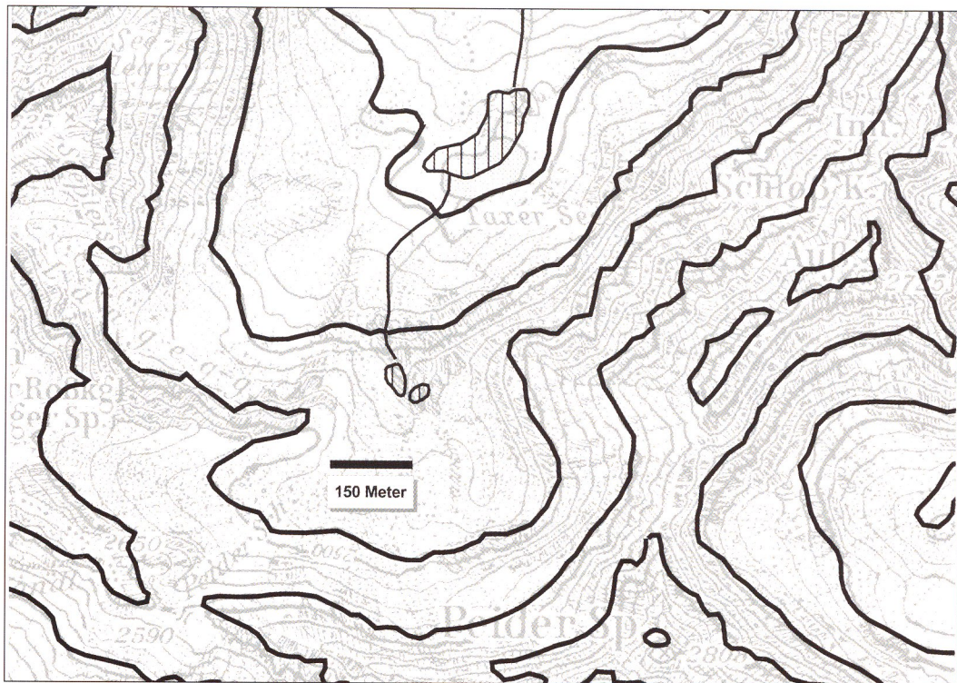
Abb. 12: Maschenweise Affintransformation innerhalb einer Dreiecksfacette im Bereich Taxer See: Hintergrund (grau): Transformierte Alpenvereinskarte. Vordergrund (schwarz): Auf der ÖK 50 digitalisierte Seen, Bäche und 100 m–Schichtlinien.
