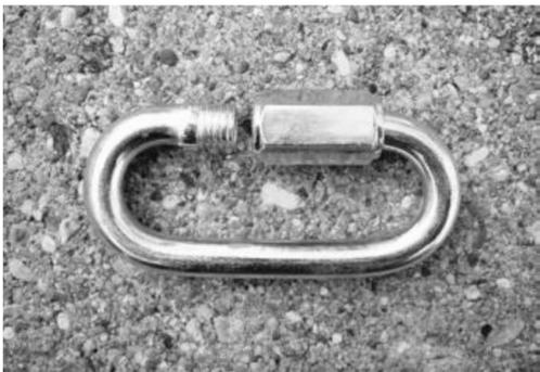
*Links: Schraubglied nach Längsbelastung im offenen Zustand mit zweifachem Körpergewicht, nur geringe Verformung.*
