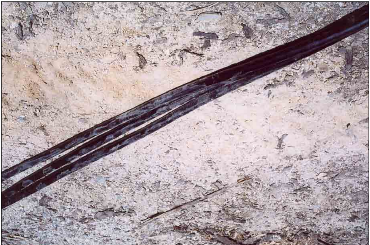
Bei großen S wurde das ausgelegte 20 kV-Kabel von schweren Fahrzeugen überfahren.
