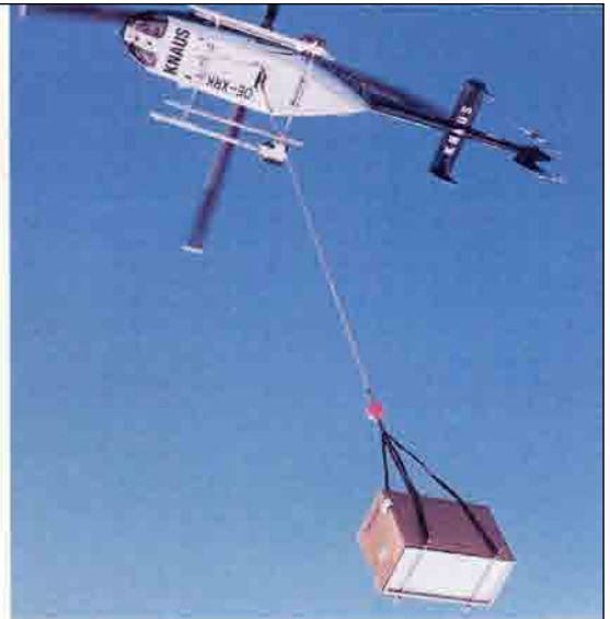
▲ Die Wärmepumpe wurde mit dem Hubschrauber zur Hütte geflogen
