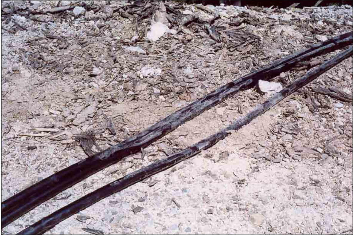
Bei großen S wurde das ausgelegte 20 kV-Kabel von schweren Fahrzeugen überfahren.
