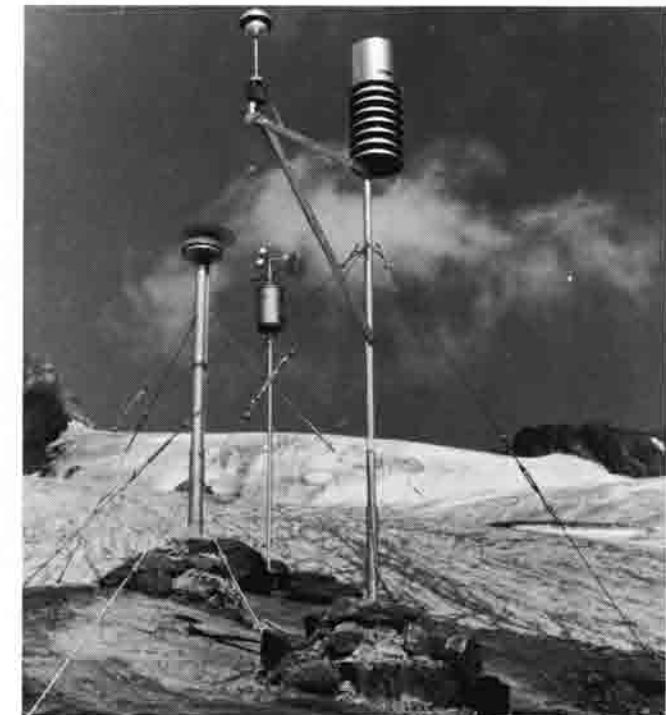
Abb. 9: Klimastation Gletschermitte am Vernagtferner in 3075 m Höhe. Im Vordergrund sind die Meßfühler für Temperatur (Kugelhütte) und Luftfeuchte (Jalousiehütte) erkennbar, dahinter steht das Strahlungsmeßgerät und der Windschreiber. Im Hintergrund der Aufschwung zur Hochvernagtspitze. Aufnahme O. Reinwarth, 1974.
