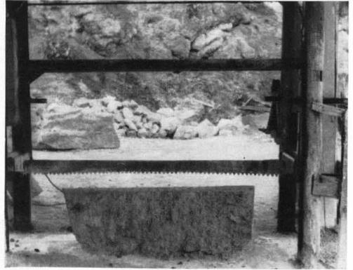
Abb. 9 Unter einer maschinell betriebenen Säge
