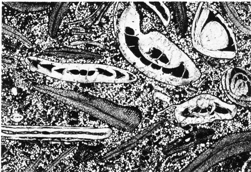
Bild 1 Vererzter Foraminiferensandstein, Dünnschliff, Vergr. zehnfach
