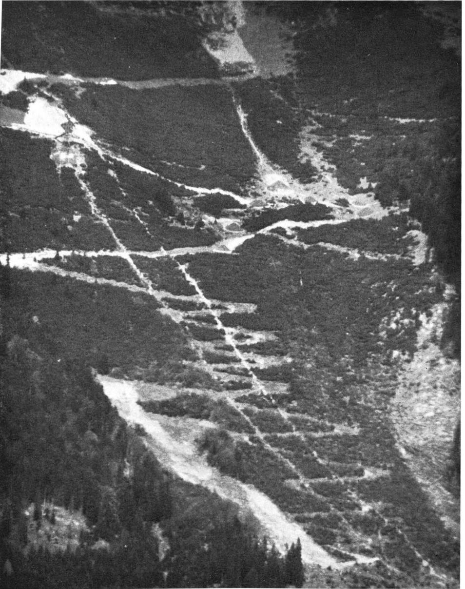
Abb. 1 Durch Kabelverlegung und Skipistenbau verursachte Schneisen in Legföhrenbeständen. Obwohl seit vielen Jahren nicht mehr benutzt, kommt es zu keiner Verjüngung, aber zu Erosionsschäden. Das Landschaftsbild ist auf Jahrzehnte hinaus zerstört.
