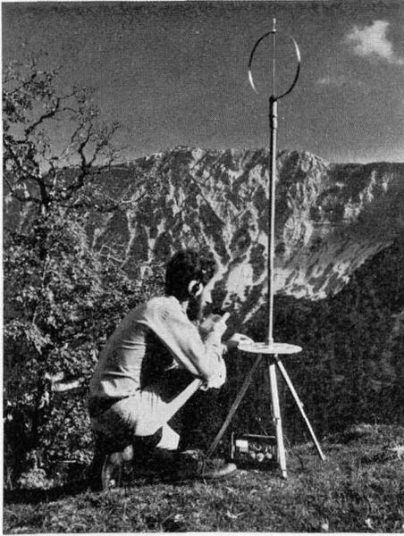
Abb. 7 Peileinrichtung zur Ermittlung des Standortes von radiotelemetrisch markierten Rothirschen in den Ammergauer Bergen.
