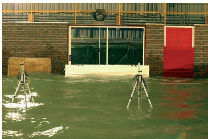
Abb. 5: Test von Damm- balkenverschlüssen in einem Prüflabor (Bild: HR Wallingford Ltd.).
